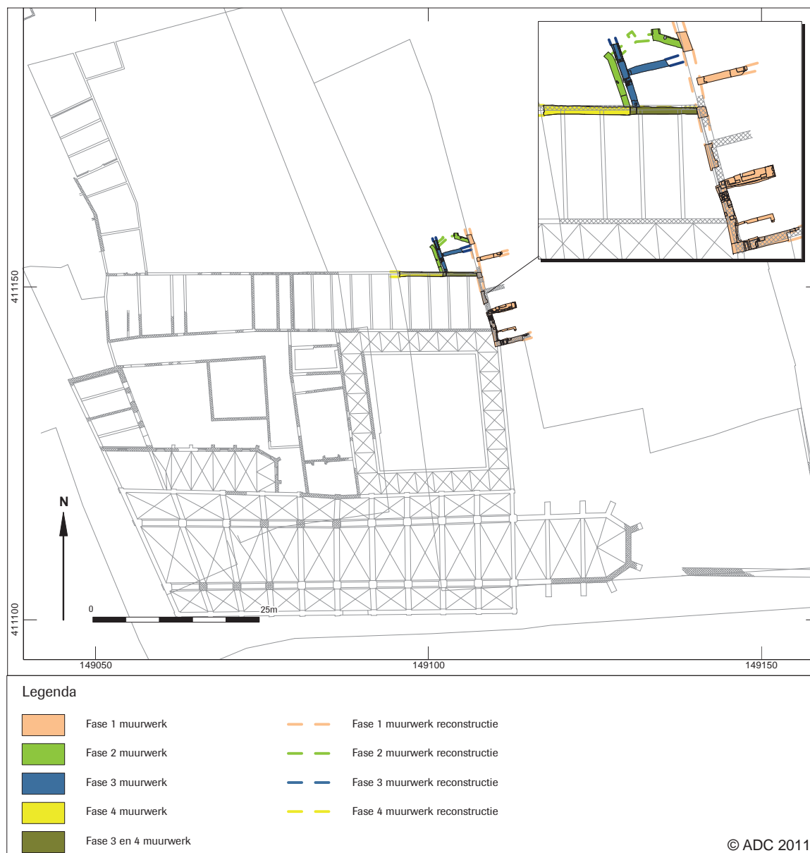
Afb. 2 Reconstructietekening van het Minderbroedersklooster op grond van bouwhistorische en archeologische gegevens. De gearceerde delen zijn opgegraven en/of opgemeten. Bron: Van Drunen 2006, 47.
