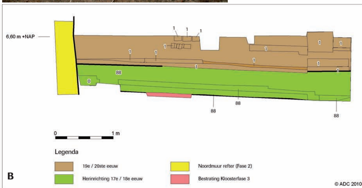
Afb. 28 A: Detailfoto aanzicht van de voorgevel F1/F88. Zichtbaar is de dubbele fasering van de voorgevel. De oudste fase is gefundeerd op het straatwerk F63). B: Detailtekening van de voorgevel en de fasering ervan. C: Detailfoto aansluiting van de voorgevel (F1/F88) op de zijgevel van het naastgelegen pand.
