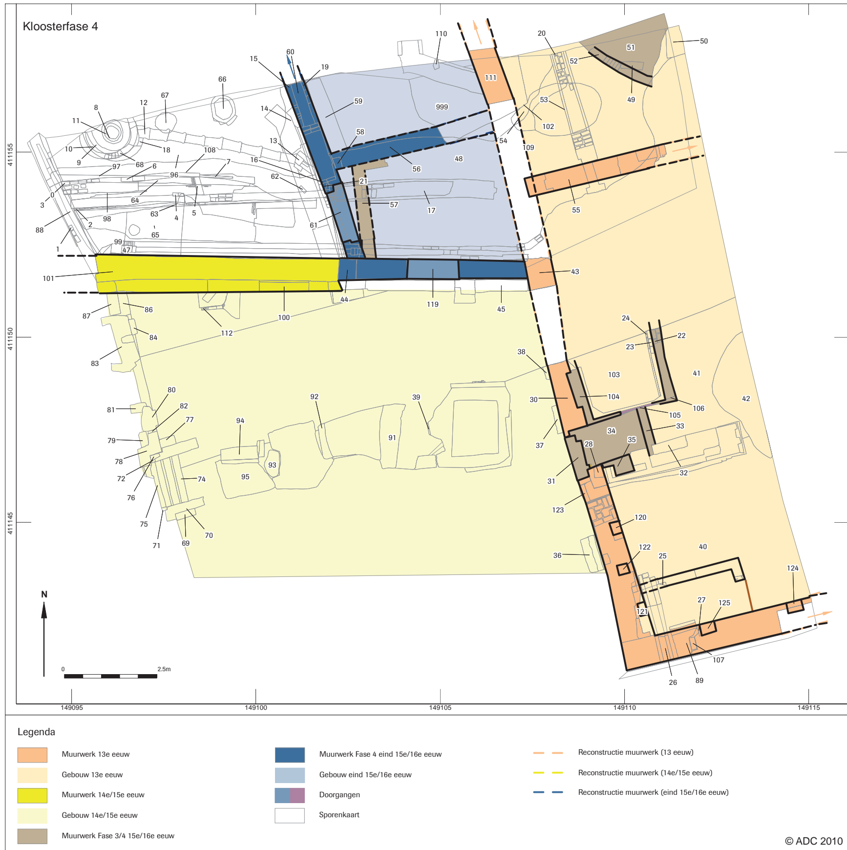
Afb. 15 Overzichtstekening Fase 4: nieuwe aanbouw van een kloostervleugel en verbouwingen binnen de bestaande bouw.
